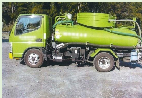
し尿及び浄化槽汚泥の収集車
